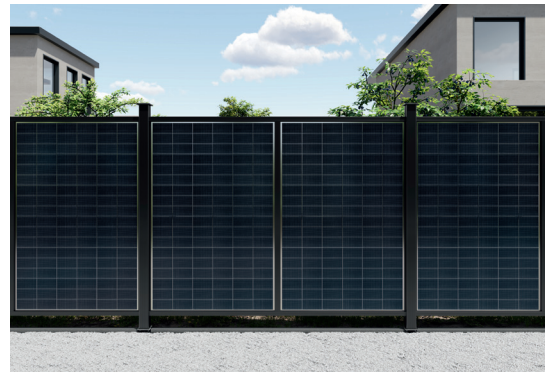
Ein Solar-Fence Element besteht wahlweise aus einem oder zwei bifazialen Glas-Glas-Solarmodulen, welche beidseitig aktiv sind und sowohl direkte Sonneneinstrahlung als auch indirektes Licht für die Stromerzeugung nutzen. (Foto: Osmo)
