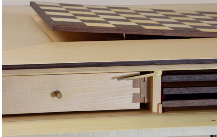
Detail: Mechanismus zum Auswechseln der Spielbretter
